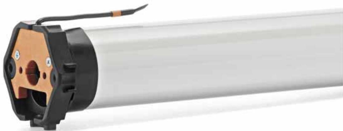
O tamanho do motor M está disponível com binários de até 50 Nm, nos escalonamentos de 6 Nm, 7 Nm, 10 Nm, 12 Nm, 20 Nm, 30 Nm, 40 Nm e 50 Nm. A velocidade de rotação padrão dos motores M RevoLine é de 14 rpm. Estão disponíveis com 23 rpm até 12 Nm. O modelo de saída é igual em todos os motores RevoLine e garante uma transmissão de força elevada. Todos os motores são adequados para montagem no lado esquerdo e no lado direito.
