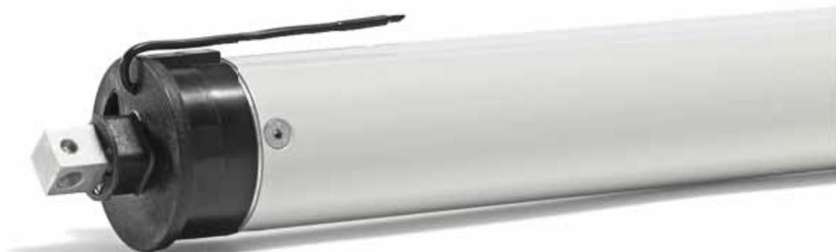
Os motores tipo 11 com saída RevoLine estão disponíveis com binários de 100 Nm a 120 Nm. O ajuste mecânico das posições finais é de fácil acesso, altamente preciso e assegura a máxima precisão de repetição possível.
