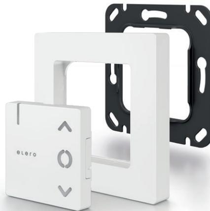
Tous les émetteurs muraux Son se composent de l'organe de commande, d'un cadre normalisé de 50 x 50 mm adapté aux gammes courantes d'interrupteurs et d'un support pour une fixation correcte au mur.
