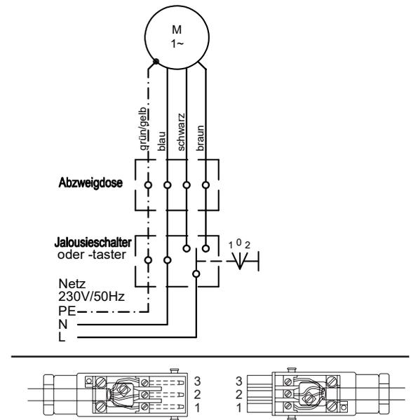
Fig. 5 Schaltbild SunTop/Z 230 V / 50 Hz und Kabelbelegung bei Verwendung mit Steckverbindung STAS-3
