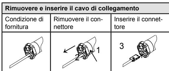
Fig. 4 Rimuovere e inserire il cavo di collegamento
