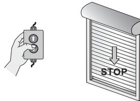
5. Faites tourner le moteur lentement jusqu'à la butée inférieure.
