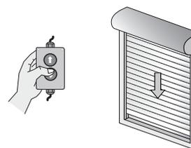
5. Faites tourner le moteur jusqu'à la position finale inférieure souhaitée.
