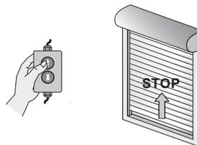
6. Maintenez la touche **MONTÉE** enfoncée jusqu'à ce que le moteur s'arrête automatiquement.
