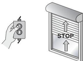
1. Déplacez le tablier jusqu'à environ 5 cm avant la butée supérieure.
