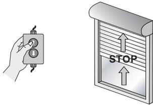
1. Déplacez le tablier jusqu'à environ 5 cm avant la butée supérieure.
