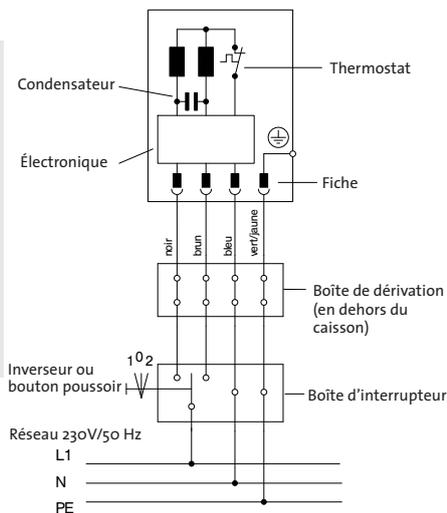
**Remarque :** Connexion en parallèle seulement avec relais de coupure.
