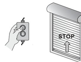
6. Maintenez la touche **MONTÉE** enfoncée jusqu'à ce que le moteur s'arrête automatiquement.
