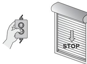
5. Faites tourner le moteur jusqu'à la butée inférieure.
