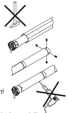
Die Befestigung des Antriebs am Wandanker und die Montage des Behangs an der Welle erfolgt durch Verwendung der passenden Motorlager und Adapterkomponenten entsprechend der gebäudeseitigen Voraussetzungen und je nach Behangart mit geeigneten Verbindungselementen auch seitens der Systemlieferanten.
